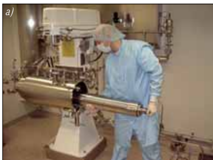
Obr. 3.12 - skládání kontinuální centrifugy(a); skládání kontejnerového systému stavby čistých prostor(b) - Sicor Biotech, Litva
