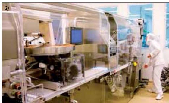
obr. 1.6. - Blistrovací linka – balení léčiva do primárního obalu (a), výroba měkké želatinové tobolky – formování želatinového obalu a jeho plnění léčivem (b)
